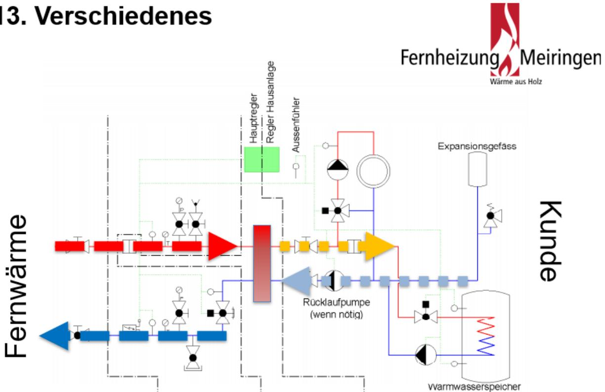
Auf dem ersten Schema-Bild zeigt er den Wärmefluss über den Wärmetauscher und die Rücklieferung über die Rücklaufpumpe.
