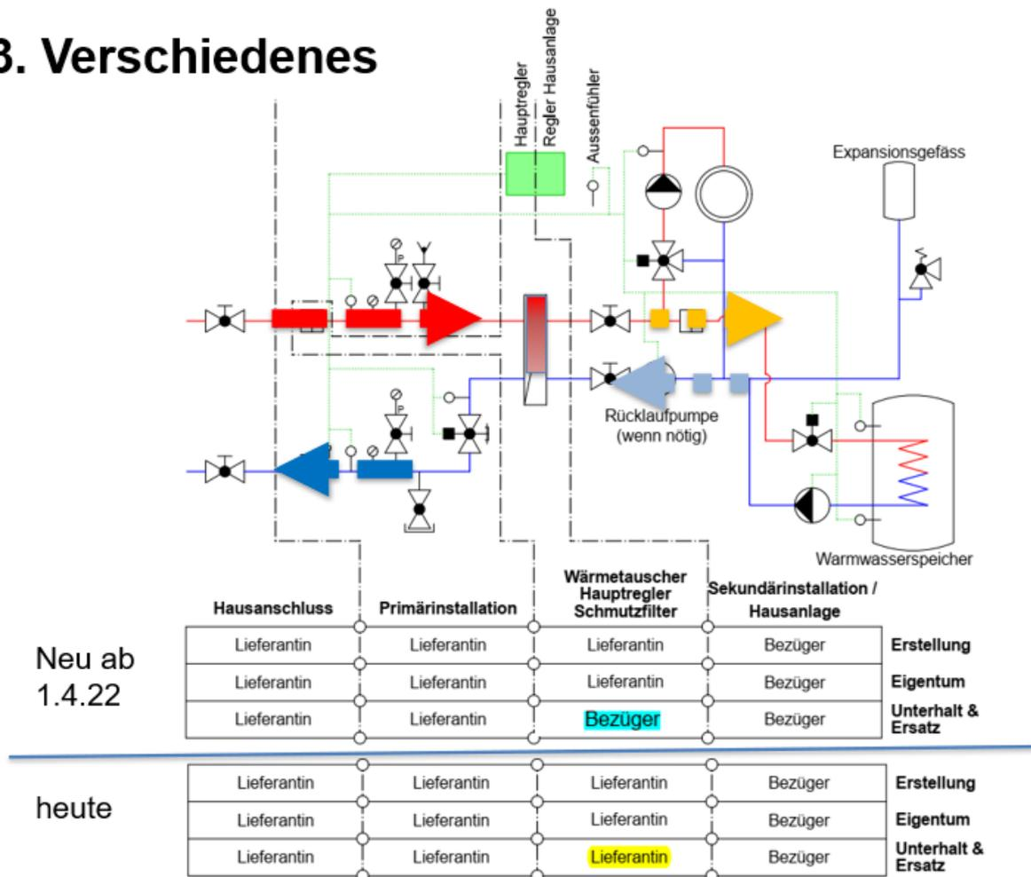
In dieser Matrix wechselt für den Wärmetauscher, Hauptregler und Schmutzfilter der Unterhalt und Ersatz von der Lieferantin zum Bezüger. Die Abgrenzung der Verantwortlichkeit ist in diesem Schema gut ersichtlich. Das System des Fernheiznetzes und des Hausnetzes haben ihren Berührungspunkt im Wärmetauscher. Wenn beide Netze gut gewartet werden, werden auch keine Probleme entstehen. Diese Thematik möchten wir gerne mit allen Wärmekunden an einer Informationsveranstaltung besprechen.
